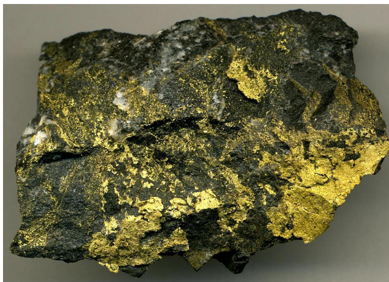
Basalto alterado a carbonatos con abundante mineralización aurífera. Mina Red Lake (Canadá) (imagen®).
