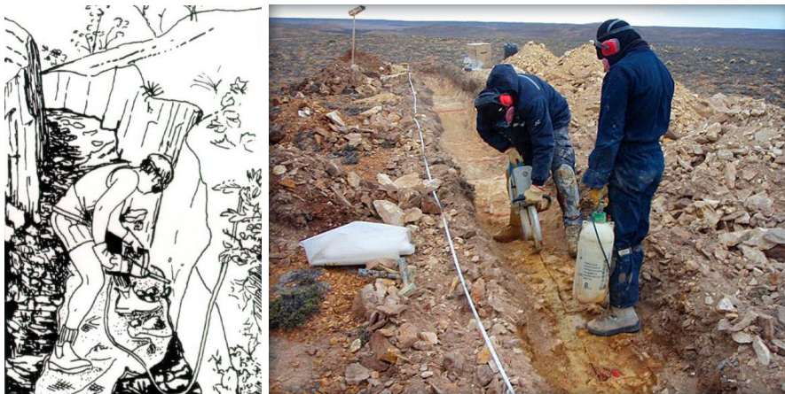
Toma de muestras en roza continua ( channel sampling ). A la izquierda con martillo neumático (Marjoribanks, 1997); a la derecha, uso de una sierra de cortar roca (imagen 3 ).
