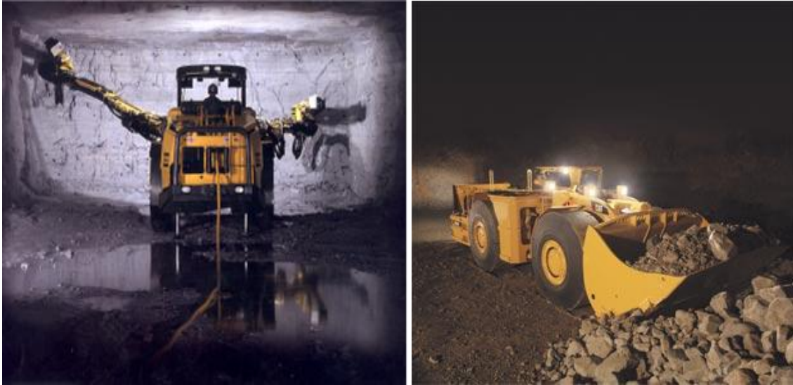
A la izquierda, Jumbo perforando con sus dos brazos articulados (visto desde atrás); a la derecha, equipo LHD en operación de carga (imágenes 3,4 ).
