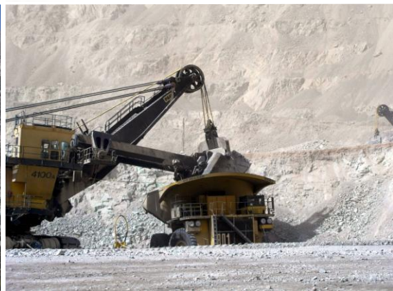
A la izquierda los bancos, donde se pueden apreciar colores verdes y rojizos que representan a los oxidados de cobre y hierro; a la derecha, operación de carga de uno de los grandes camiones. Mayo de 2006.
