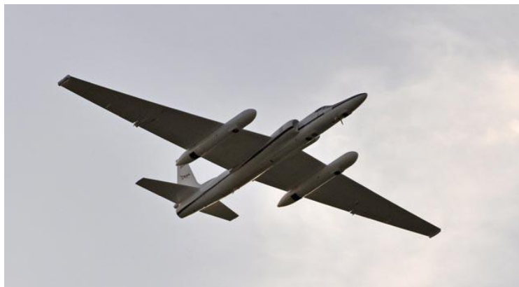
El avión ER-2 de la NASA con un instrumento AVIRIS avanzado del JPL (imagen 12 ).
