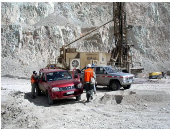
Preparación de un banco para voladura. A la izquierda, perforadora; a la derecha, hueco de perforación (Mayo de 2006).
